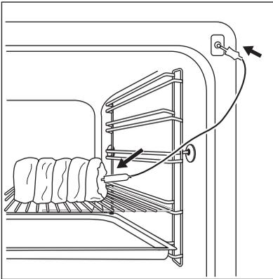
3. Stecken Sie den Stecker des Speisethermometers in die Buchse an der Vorderseite des Geräts.
