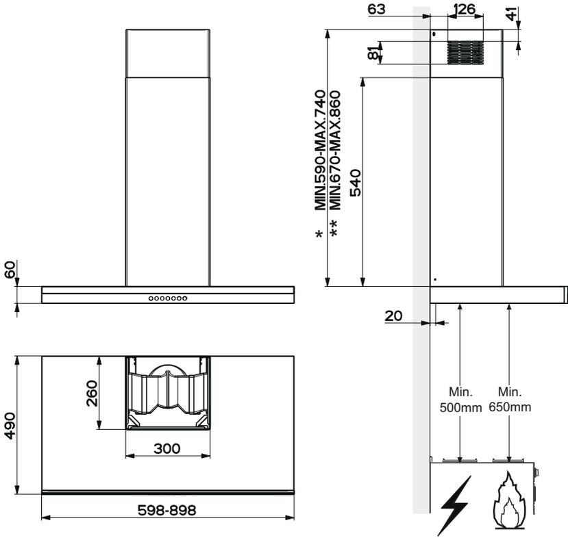
\* Abmessungen der Haube in Abluftversion.
